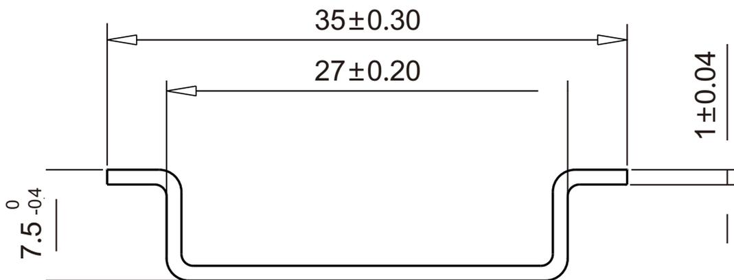
图 2 安装轨尺寸
