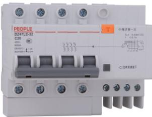
DZ47LE系列剩余电流动作断路器适用于交流50Hz、额定电压230/400V,额定电流至32A(63A)的线路中,作为负载线路的漏电(触电)、过载和短路保护。也可作为不频繁接通、分断和转换之用。
