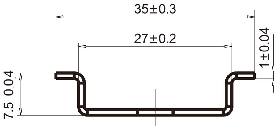
图2 安装轨尺寸
