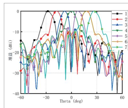
馈电波导改变时天线 H 面方向图
