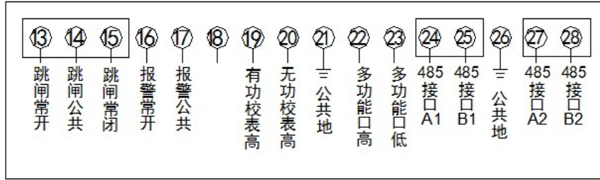
图 3：主端子与功能端子接线图
